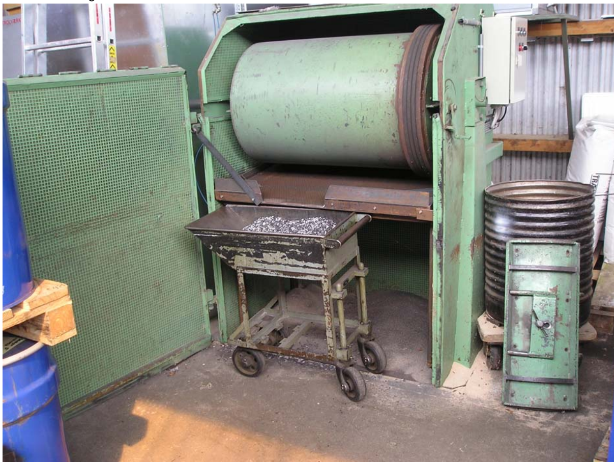
Foto 17: Bygning 14 (rum 101b), slibemaskine til slibning af blykerner til projektiler.
