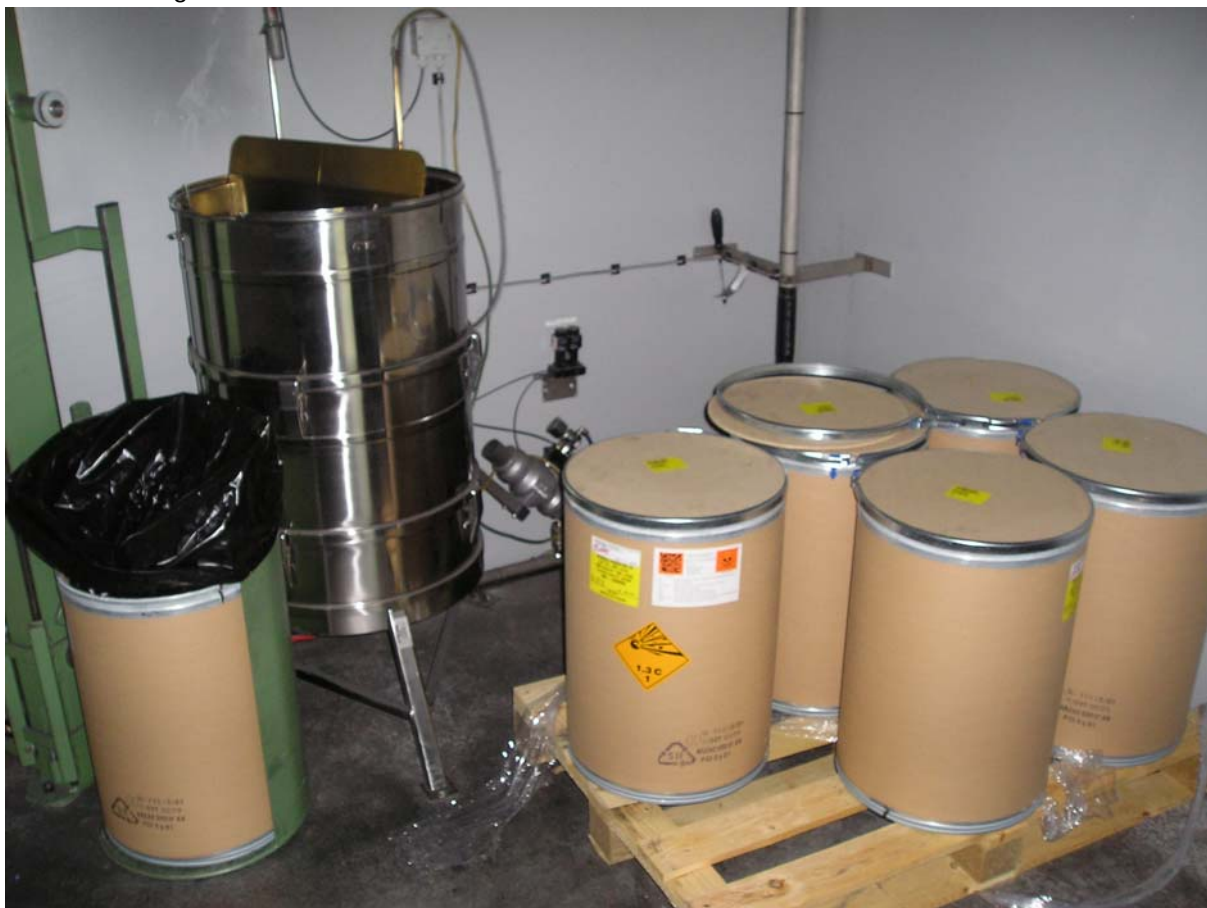
Foto 33: Bygning 21, oplag af røgsvag krudt. Krudtet suges fra bygningen ind i bygningen 20.
