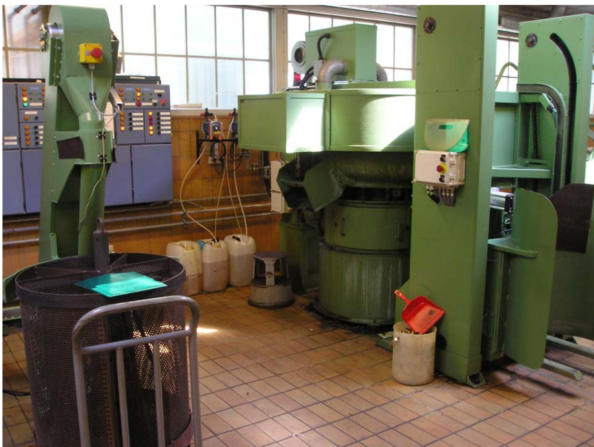
Foto 14: Bygning 14, Bejdseanlæg til bejdssning af patronhylstre og projektilhylstre.
