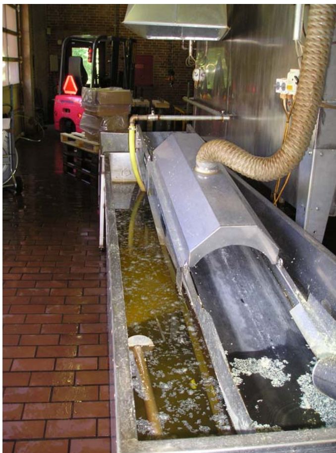
Foto 19: Bygning 16, vandkar hvortil udsmltet trotyl tilledes. Trotylet størkner i vandkaret og føres videre til tørring i det næste kar.
