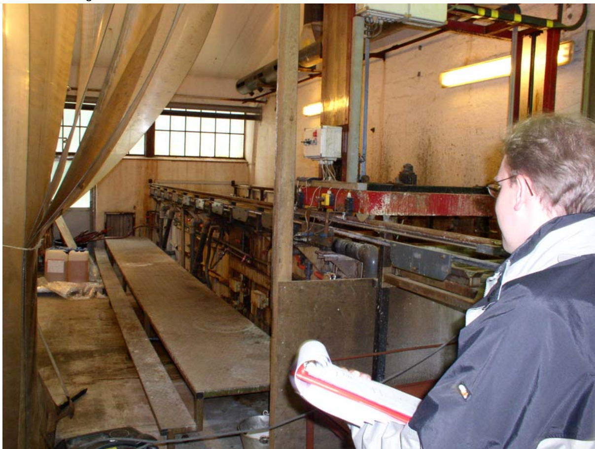
Foto 11: Bygning 11, syrerum med kemikaliebade brugt til forskellige overfladebehandlingsprocesser.
