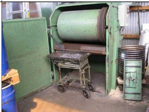
Foto 3: Slibemaskine til slibning af blykerner til projektiler, opstillet i rum 101b.
