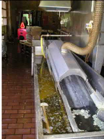
Foto 1: Vandkar hvortil udsaltet trotyl ledtes til. Trotylet størknede i vandkarret og førtes videre til tørring i det næste kar.
