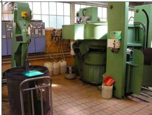
Foto 1: Bejdseanlæg til bejdning af patronhylstre og projektilhylstre.
