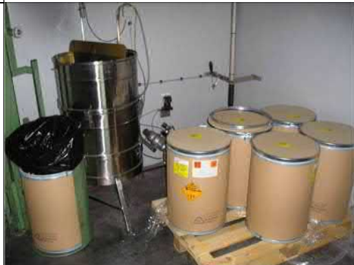
Foto 1: Oplag af røgsvagt krudt i bygning 21. Krudtet suges fra bygning 21 ind i bygning 20.
