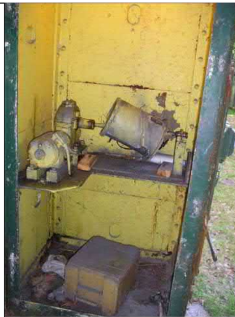
Foto 2: Satsblandeskur ved bygning 27. I 2004 blandes aluminiumspulver, bariumnitrat og kaliumperchlorat.
