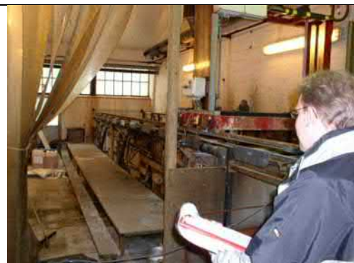
Foto 2: Syrum med kemikaliebade brugt til forskellige overfladebehandlingsprocesser (rum 102b).
