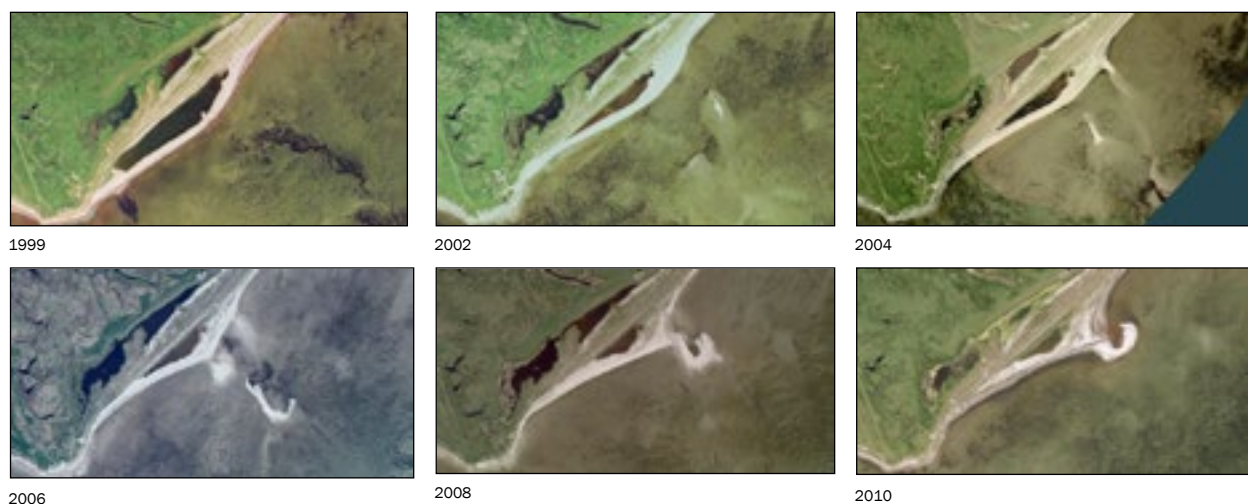
Figur 4-8: Kystdynamik ved Aflandshage illustreret ved fotos af det samme kystudsnit fra perioden 1999-2010 DDO®, Copyright COWI.
