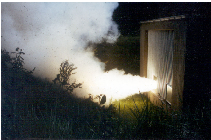
Affyring af raketmotor i prøvestand missilværkstedet.
