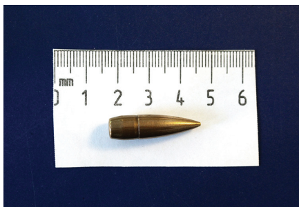
BILLEDE 9.1 | Billedet viser et uaffyret standard NATO projektil af typen 7.62 x 51 mm. fuldkappe. Foto: Stabslæge 2 af reserven P. Thiis Knudsen, FSU.
