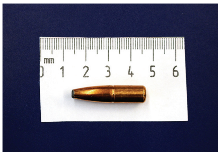
BILLEDE 9.3 | Billedet viser et uaffyret ekspanderende projektil af typen 7.62 mm. soft point, dvs. at kappen ikke dækker kernen og blyet derfor er synligt i spidsen. Foto: Stabslæge 2 af reserven P. Thiis Knudsen, FSU.
