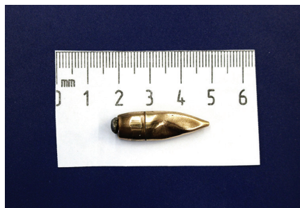
BILLEDE 9.2 | Billedet viser et affyret NATO projektil af typen 7.62 x 51 mm. fuldkappe. Projektilet er udtømt fra gelatineblokke. Foto: Stabslæge 2 af reserven P. Thiis Knudsen, FSU.
