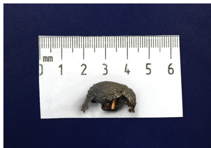
BILLEDE 9.4 | Billedet viser et affyret ekspanderende projektil af typen 7.62 mm. soft point, dvs. at kappen ikke dækker kernen og blyet derfor er synligt i spidsen. Projektilet er udtømt fra gelatineblokke. Foto: Stabslæge 2 af reserven P. Thiis Knudsen, FSU.
